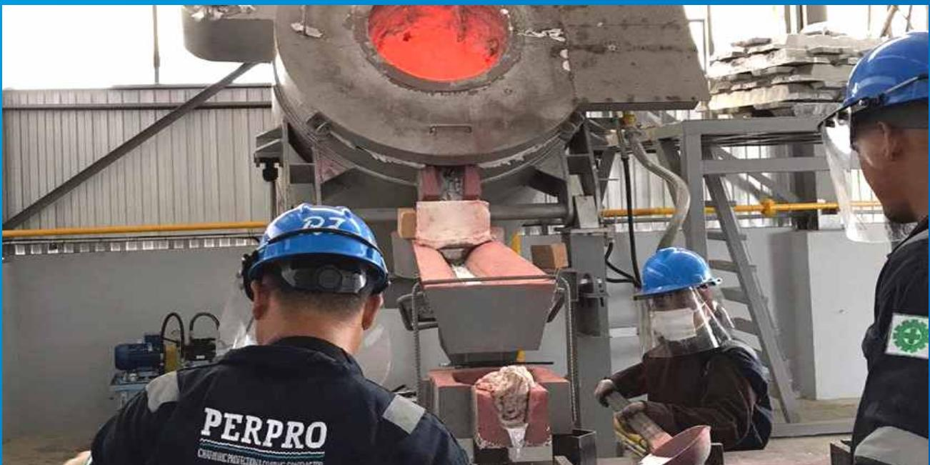
**I. Sacrificial Anode Cathodic Protection** Prinsip kerja cathodic protection sacrifcial anode adalah: Metal seperti zinc, aluminium, dan magnesium sifatnya lebih reaktif terhadap unsur karat dan mempunyai titik oksidasi yang lebih rendah dibandingkan besi sehingga saat dipasang pada metal lain seperti besi, Sacrificial Anode lebih dahulu bereaksi terhadap karat sehingga menetralisir karat sebelum menyerang besi.
